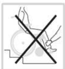
レッグサポートを持って、車いすを持ち上げないでください
